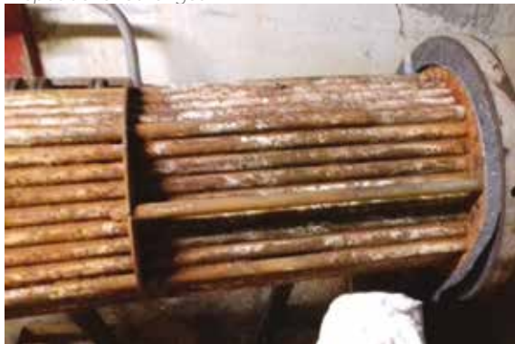
Dépôt de fer échangeur
